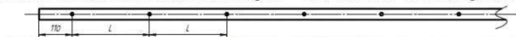
L=287 мм (для лестницы с шагом 180 мм) и L=317 мм (для лестницы с шагом 225 мм)
